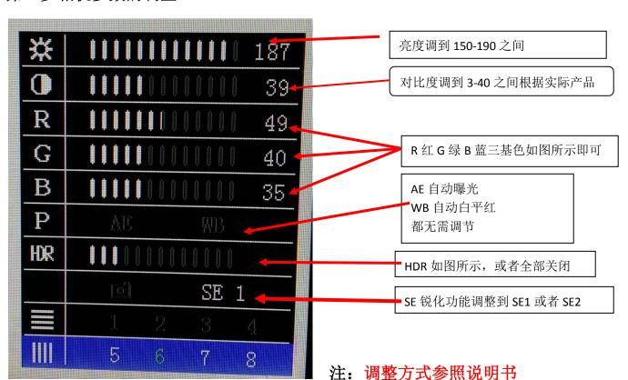
第二步:安装使用说明书完毕机器后我们检查机器,如下图操作.
